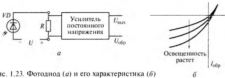
Рис. 1.23. Фотодиод (а) и его характеристика (б)
