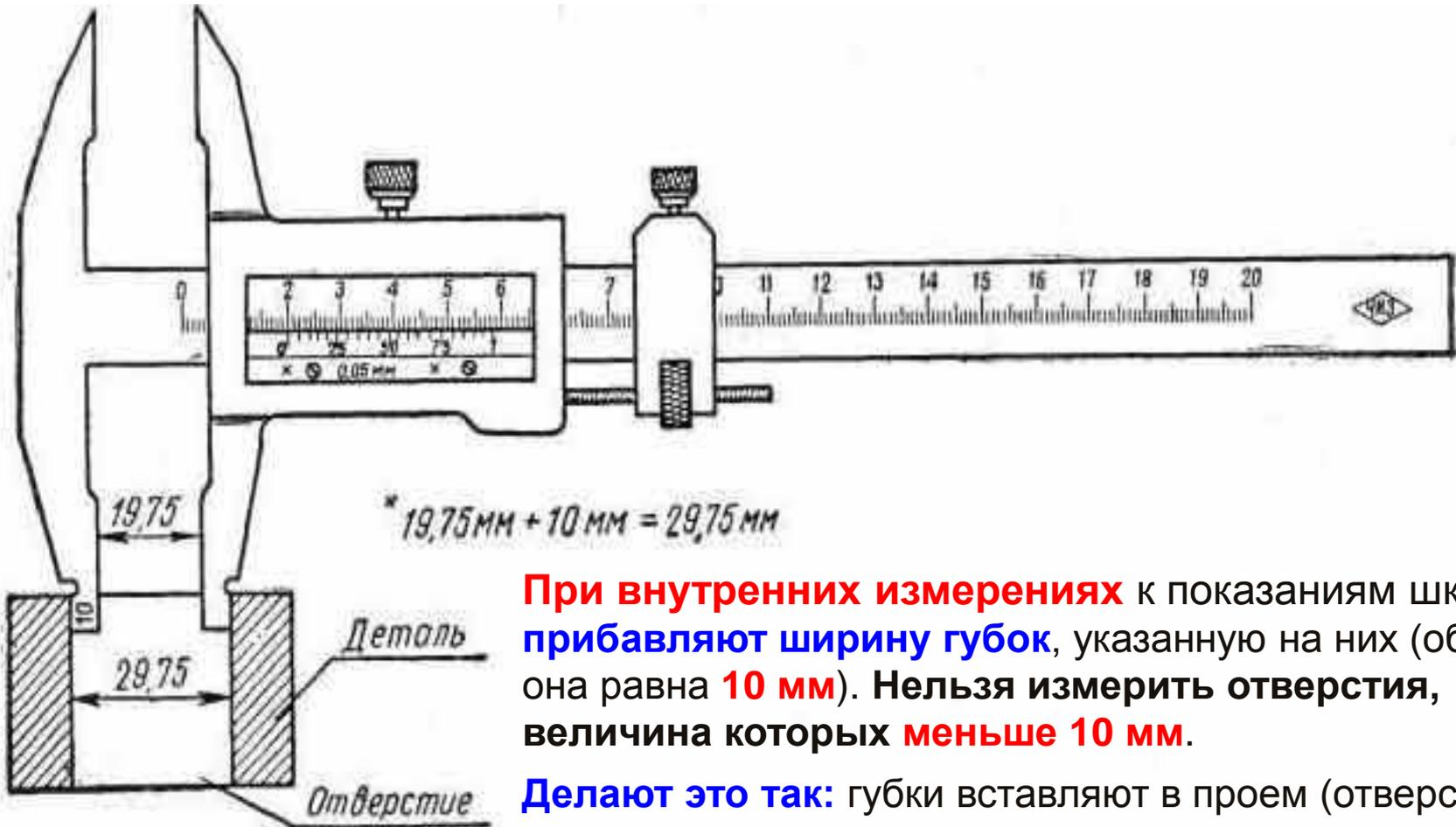
**При внутренних измерениях** к показаниям шкалы **прибавляют ширину губок**, указанную на них (обычно она равна **10 мм**). **Нельзя измерить отверстия, величина которых меньше 10 мм.**
