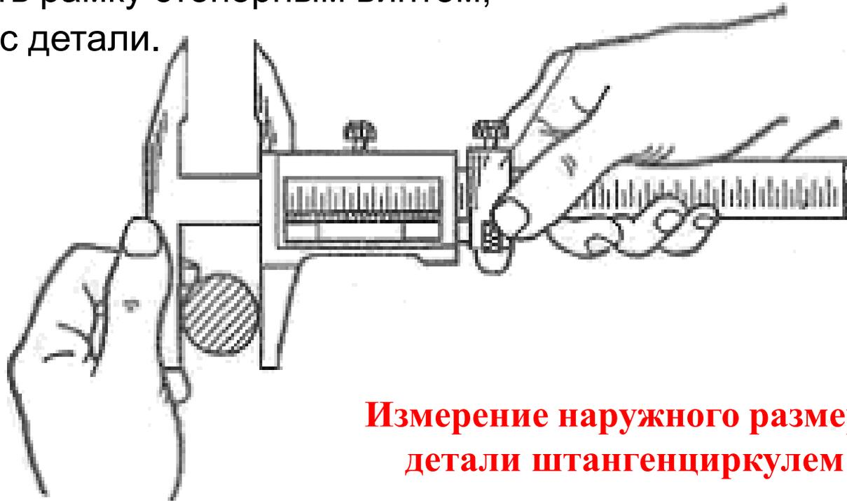
**Измерение наружного размера детали штангенциркулем**
