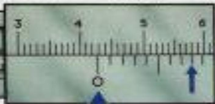
$$42 \text{ мм} + 8 \times 0,1 \text{ мм} = 42,8 \text{ мм}$$
