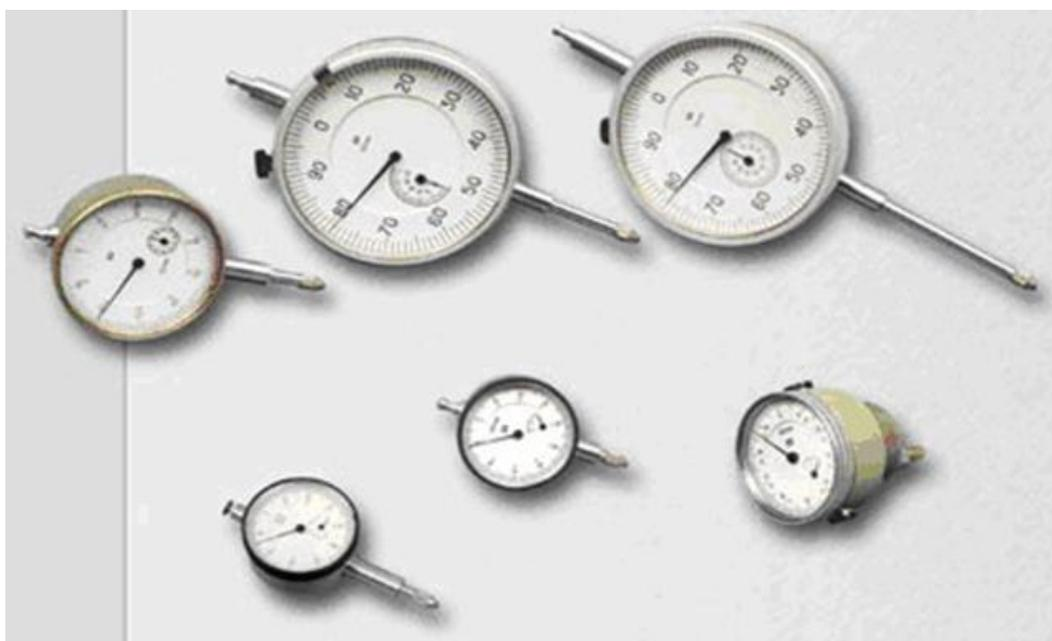
**Рисунок 5 – Индикаторы часового типа**
