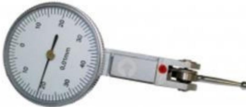
Рисунок 2 – Индикатор рычажно-зубчатый ИРБ
