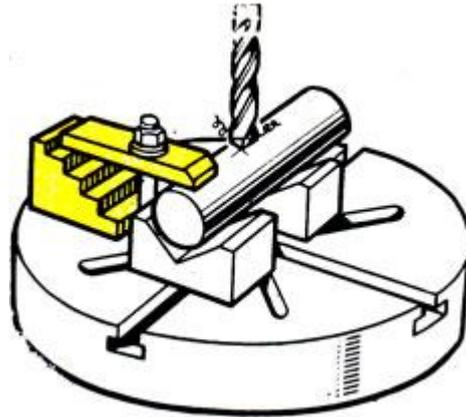
*Рис. 210. Установка и закрепление валика при помощи одного упора на призмах*
