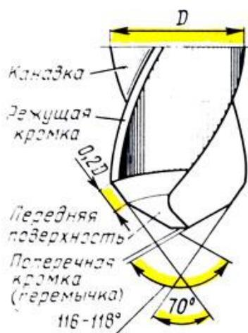
Рис. 180. Канавки и режущие кромки спирального сверла
