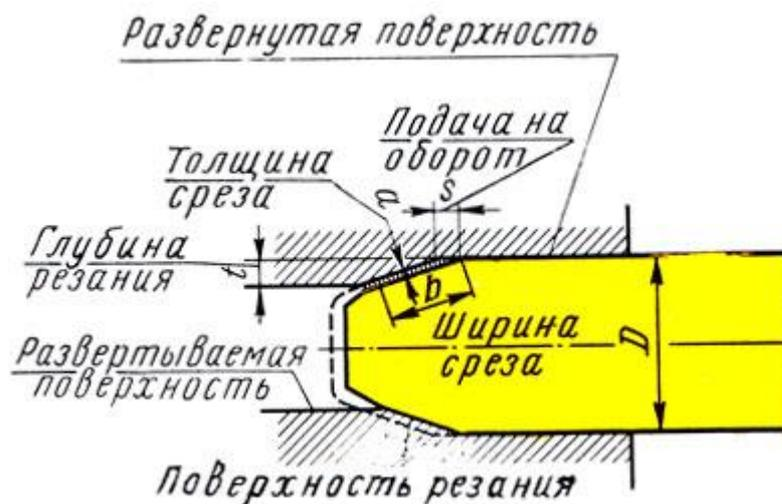
**Рис. 249. Элементы резания при развертывании**
