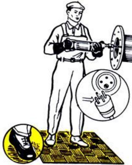
*Рис. 197. Безопасная работа сверлильной электрической машиной*
