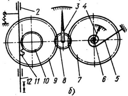
Рисунок 3 – Принципиальная схема индикатора ИЧ
