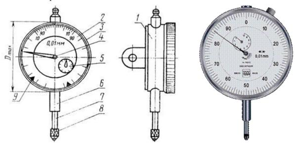
Рисунок 2 – Устройство индикатора часового типа ИЧ-10
