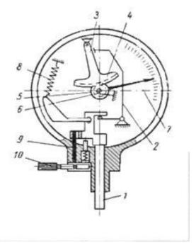
Рисунок 7 – Устройство рычажно-зубчатой головки
