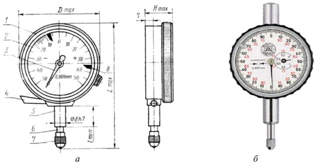
Рисунок 6 – Рычажно-зубчатая измерительная головка
