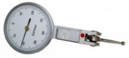
Рисунок 2 – Индикатор рычажно-зубчатый ИРБ
