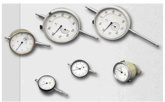
Рисунок 5 – Индикаторы часового типа
