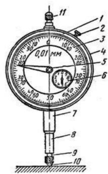
Рисунок 1 – Устройство индикатора часового типа
