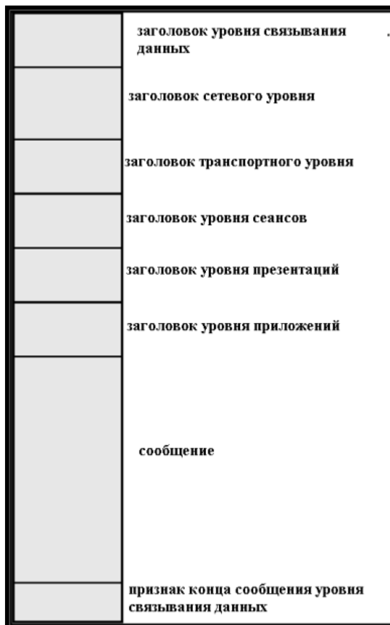
Рис. 3. Структура сетевого сообщения, согласно модели ISO.
